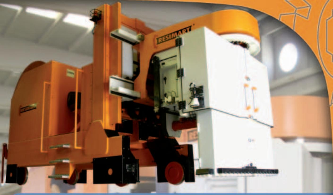
En cuanto a seguridad, todas disponen de parada automática de la máquina por falta de agua y doble sistema de seguridad para no cortar la pista (electrónico y mecánico).
