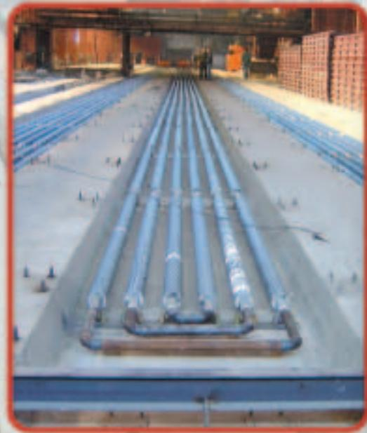
El sistema de calefacción de pistas montado por Resimart® permite obtener secados del hormigón hasta en 8 horas, lo cual acelera notablemente el proceso de fabricación. Suministramos sistemas de calefacción por agua caliente, aceite o vapor; manual o con control automático del ciclo de fraguado.
