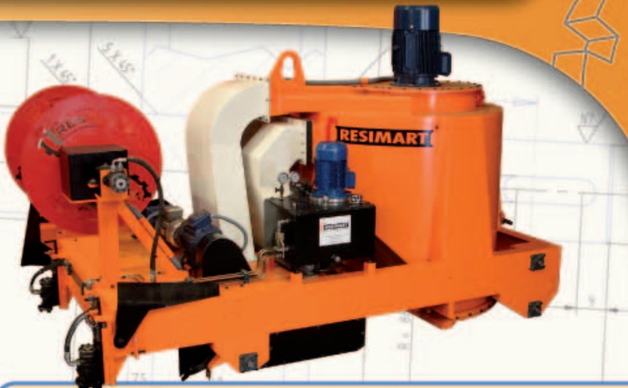
Mediante un sistema de dos rascadores laterales un triturador y un potente aspirador efectúa de manera rápida y eficiente la limpieza de las pistas en cualquier superficie. El propio efecto de la aspiración además de limpiar seca la pista por lo que evita óxidos en la chapa y mejora el efecto del desmoldeante. Se fabrica en dos versiones, con tracción eléctrica o hidráulica con la que se consigue una velocidad mayor y variable que puede servir para rociar de desmoldeante la pista una vez limpia.
