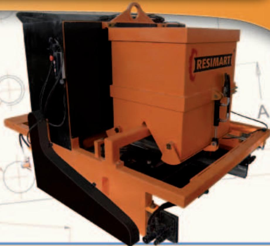
Permite realizar el fratasado superior en las placas alveolares y remoldeado de laterales, consiguiendo así un producto de mejor acabado y presencia, además de eliminar posibles defectos existentes por lo que permite aprovechar la fabricación de toda la pista. También es posible añadir segunda capa de mortero de diferentes colores.
